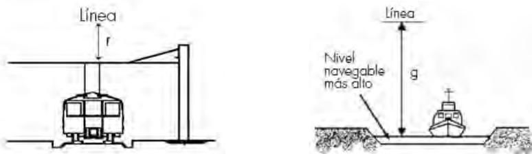
**Nota:** En el caso de tensiones línea – tierra que superen 98 kV, se podrán aumentar las distancias de la Tabla 13.2 o disminuir el campo eléctrico, considerando que el vehículo o equipo más grande esperado bajo la línea fuera conectado a tierra para limitar a 5 mA rms la corriente de estado estacionario debida a los efectos electrostáticos. Para calcular esta condición los conductores deben estar desenergizados y la flecha a 50 °C.
